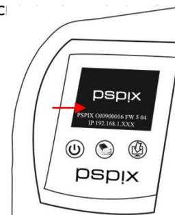
Этот тип конфигурации позволяет подключаться к сети, введя IP-адрес системы PSPiX. Если включить функцию "Enable changing IP address", то вы сможете ввести IP адрес PSPiX системы вручную.
