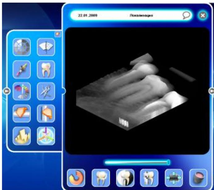
Когда инструмент включен, с помощью бегунка на шкале можно изменять положение секущей плоскости трехмерной проекции изображения.
