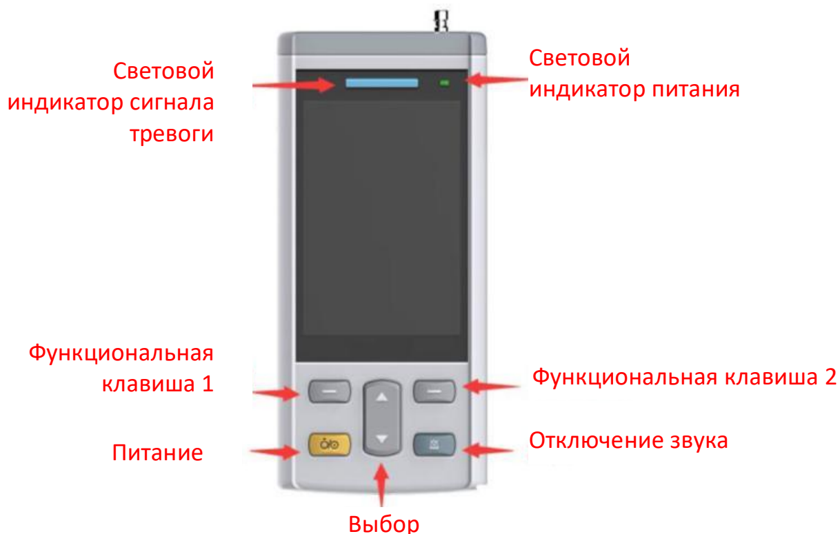
Рис. 2.1.1 Кнопки и световые индикаторные сигналы
