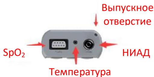
Рис. 2.4.1 Разъёмы
