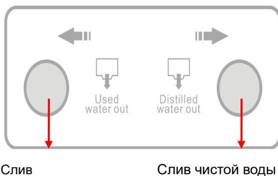
Обычно максимальная температура сливаемой воды не должна превышать 70°C. Если температура выше, вам следует проверить работу вентилятора, или немедленно связаться с местным дистрибьютором.
