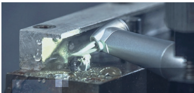
Проверка надежности фиксации бора при нагрузке более 3 кг
