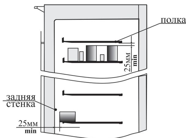
Для нормального функционирования холодильного прибора обеспечьте свободную циркуляцию воздуха внутри холодильной камеры укладывая лекарственные препараты так, чтобы по всей высоте холодильной камеры оставался зазор не менее 25 мм между лекарственными препаратами на полках и задней стенкой шкафа (воздуховодом) и боковыми стенками шкафа, а также между лекарственными препаратами и вышерасположенными полками (рис. 3).
