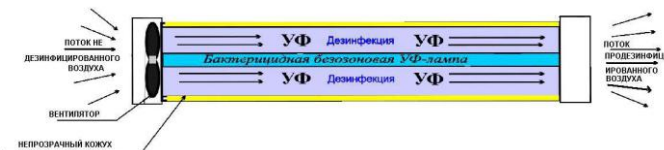
Рис. 1 - Устройство облучателей-рециркуляторов
