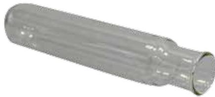
Пробирка для деструкционной установки 400 мл
