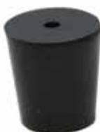
Пробка с отверстием для термометра для
