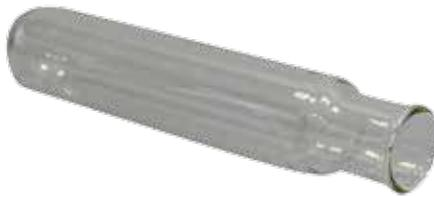
Пробирка для деструкционной установки 400 мл
