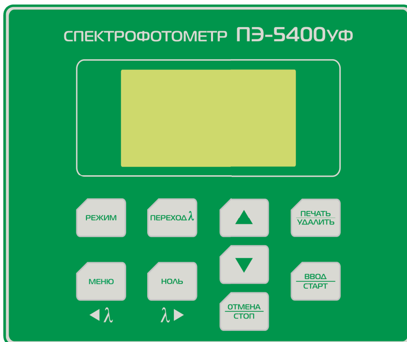
Рисунок 4 - Панель управления спектрофотометра ПЭ-5400УФ.
