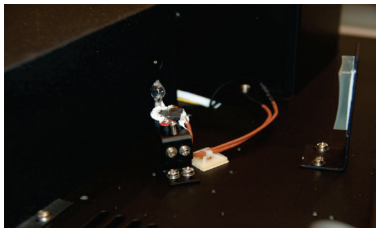
Рисунок 23 - Крепление галогенной лампы.
