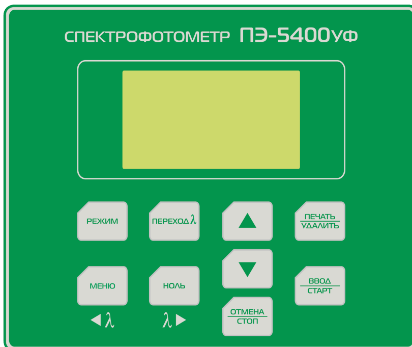
Рисунок 4 - Панель управления спектрофотометра ПЭ-5400УФ.
