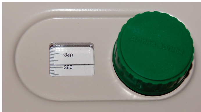
Рисунок 4 - Узел установки длины волны.
