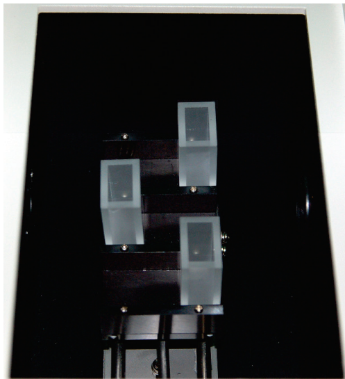
Рисунок 5 - Установка кювет в шахматном порядке.
