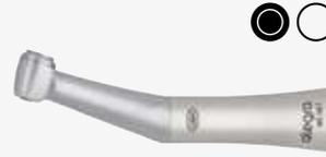
1:1, кнопочный зажим, диаметр головки 10,1 мм, для боров для угловых наконечников диаметром 2,35 мм
