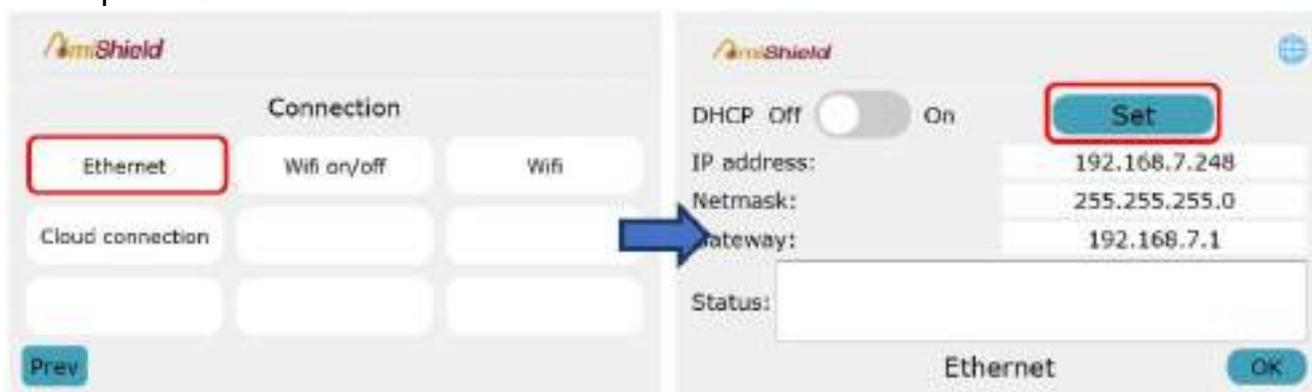
Параметр DHCP по умолчанию включен. Оставьте DHCP включенным, и сеть назначит динамический IP-адрес.
