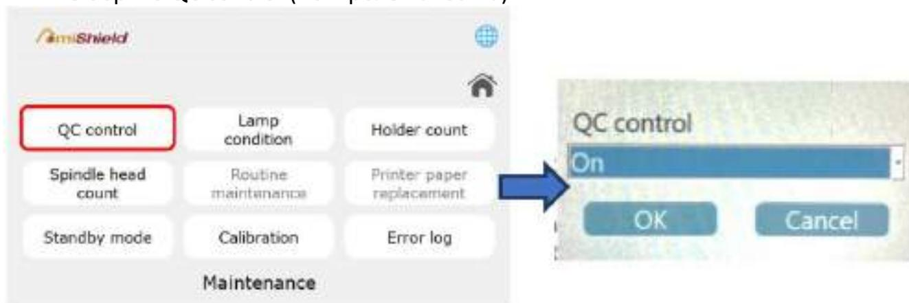
См. главу 2.6 «Контроль качества». При включении режима контроля качества в правом верхнем углу страницы **Disk Type** (Тип диска) появится всплывающее окно **QC** (Контроль качества), чтобы пользователи могли использовать функции контроля качества.
