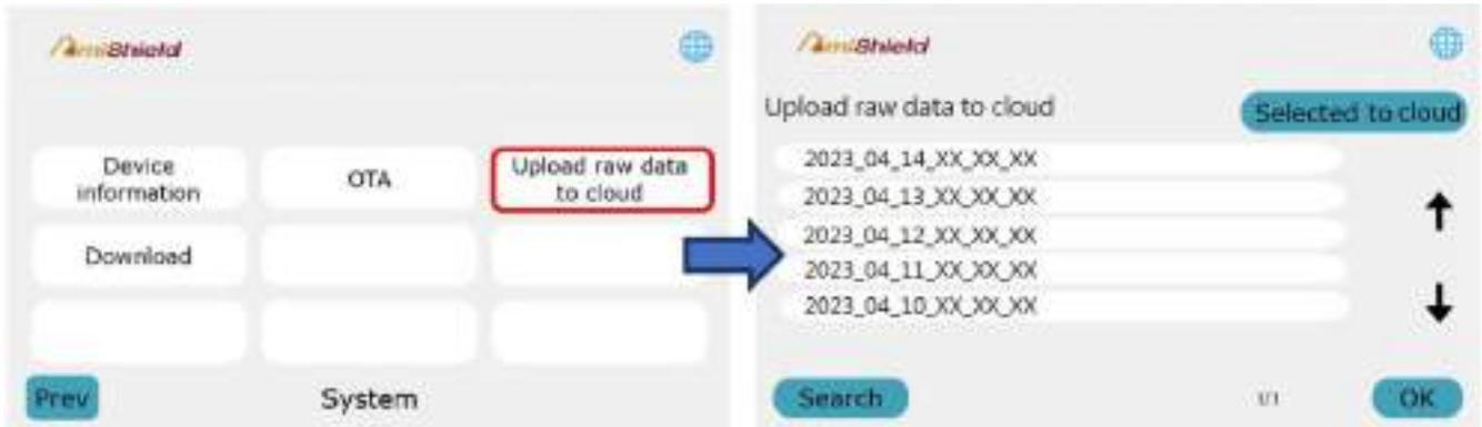
Выберите данные, которые будут загружены для поиска и устранения неисправностей дистрибьютором, чтобы лучше понять состояние анализатора.
