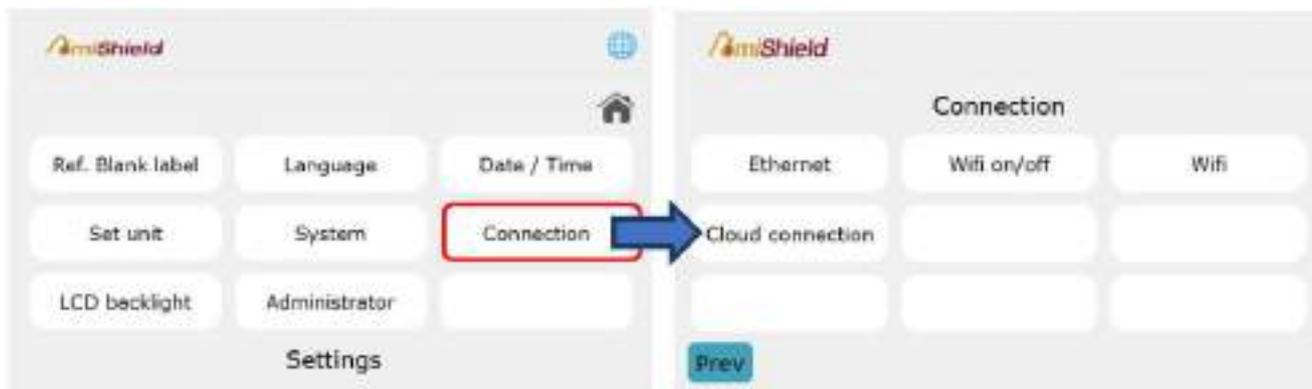
После подключения анализатор может обновлять прошивку, передавать данные на ПК через программное обеспечение дистрибьютора и загружать данные в облачное хранилище для поиска и устранения неисправностей.
