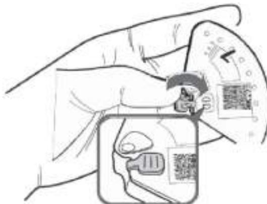
4. Важное значение имеет последовательность дисков. Отверстие на держателе (см. рисунок ниже) обозначает «Начало цикла» и является начальной точкой установки диска. Последовательность дисков начинается с отметки начала цикла и идет против часовой стрелки: диск 1, диск 2 и диск 3. Используйте эту последовательность для установки всех трех дисков; если
