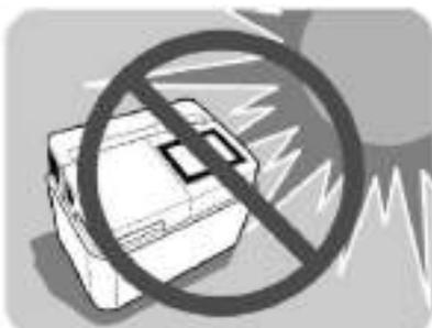
НЕ подвергайте анализатор воздействию прямых солнечных лучей или сильного ветра. В противном случае это может привести к неточным результатам, вызвать деформацию или повреждение анализатора.
