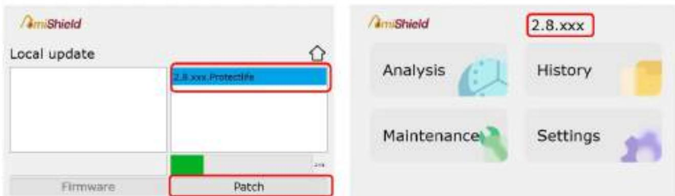
После завершения обновления перезагрузите анализатор. В правом верхнем углу главной страницы отобразится обновленная версия прошивки, например 2.8.xxx, что подтвердит обновление.
