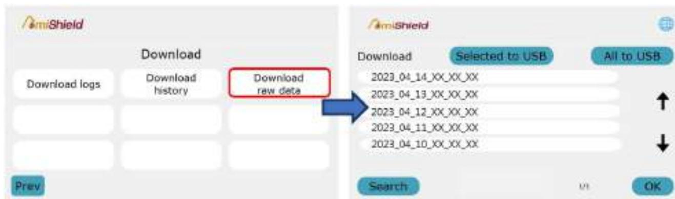
С) Подключите USB-накопитель и выберите **Download raw data** (Загрузить необработанные данные), чтобы загрузить необработанные данные из анализатора.
