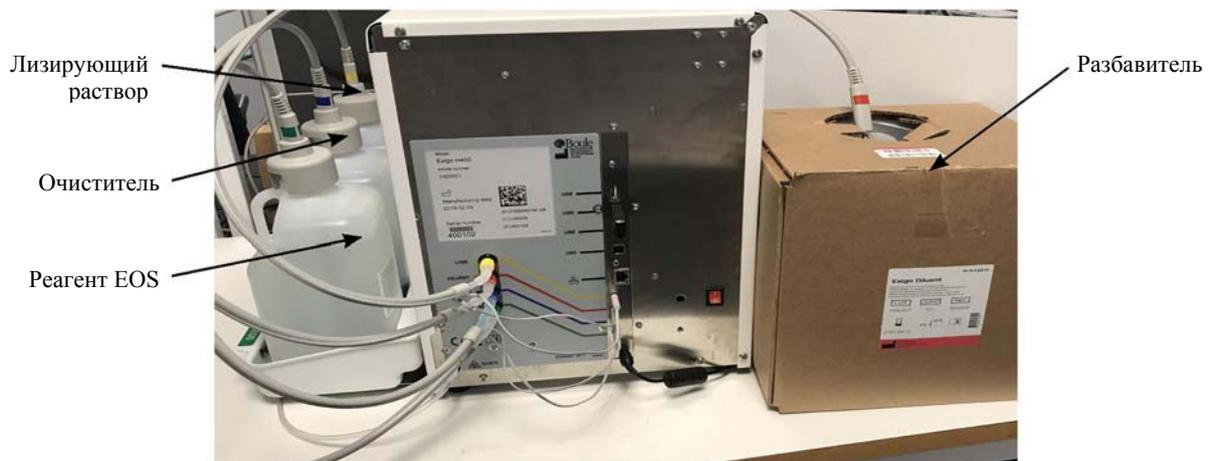
Рисунок 19: Подключение трубок для реагентов
