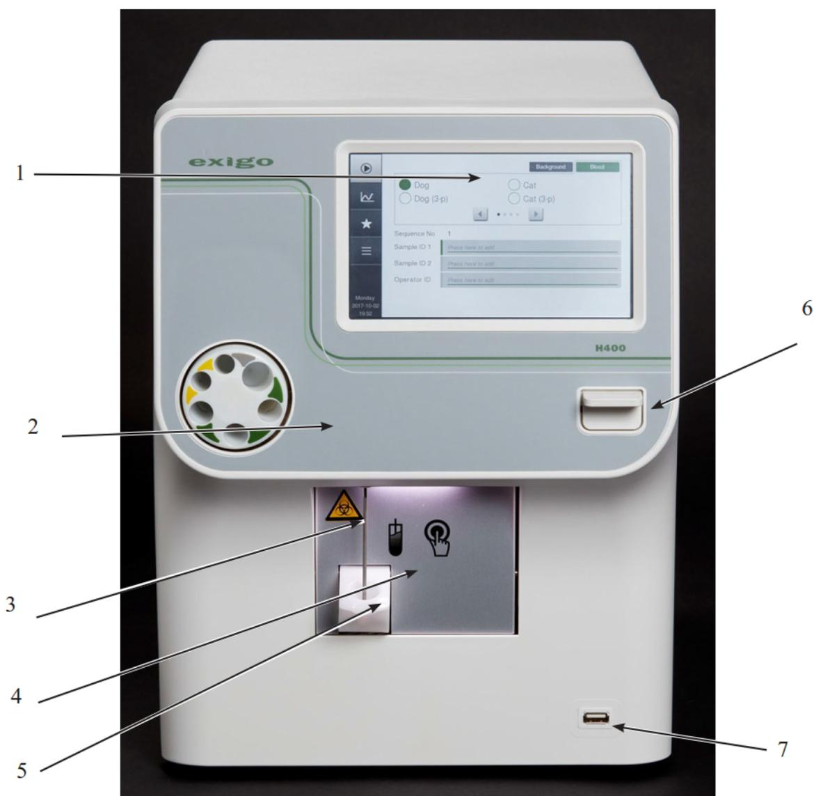
Рисунок 1: Вид анализатора спереди
