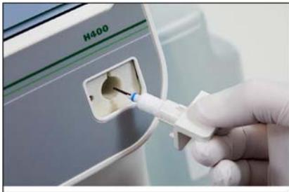
Рисунок 49: Установка МКА устройства в анализатор
