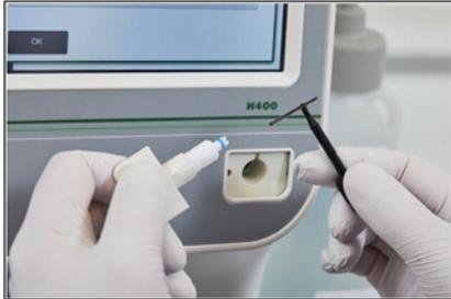
Рисунок 48: Установка микрокапилляра в МКА устройство
