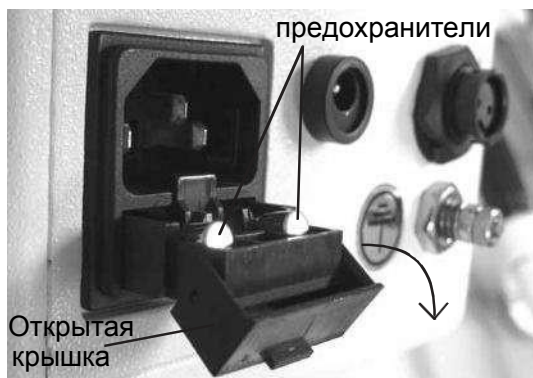
Фото 31 Открыть крышку предохранителя
