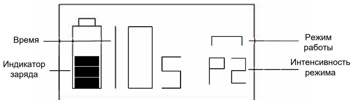
5.4 Наденьте на лампу специальный одноразовый чехол, направьте световод на место, требующее полимеризации, и нажмите на кнопку вкл./выкл. «P». Раздастся короткий звуковой сигнал, и лампа начинает работать в заданном режиме. Одновременно начинается обратный отсчет до «0» - окончания процесса полимеризации. После этого на экране снова будет показан установленный интервал работы.
