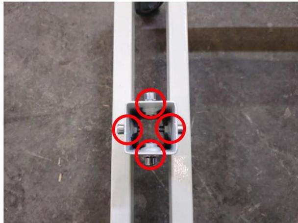
5. Установите балку до упора, чтобы отверстия на балке и основании стойки совпадали.
