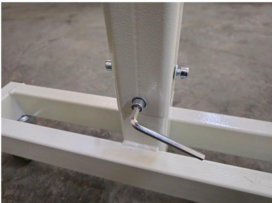
7. Для монтажа стойки с приводом открутите болты шестигранником от уже установленной балки.
