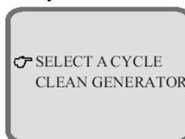
Если изделие не находится в работе, выбрать «MENU/C», затем «CLEAN GENERATOR», «OK». Это значит, вы выбрали цикл очистки. Закройте дверь и нажмите на «START».
