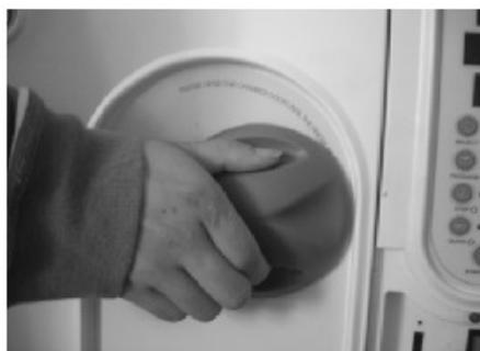
Внимание: Ручка двери должна быть повернута в запертое положение, в противном случае может происходить утечка пара во время цикла, появляется тревога и отображается ошибка Еб. Иногда трудно закрыть дверцу камеры из-за наличия пара внутри, если камера в режиме поддержания тепла. Вы можете подержать дверь открытой, пока пар и влага не выветрятся, дверь легко закроется. Вы также можете надавить на дверцу с небольшим усилием при повороте ручки
