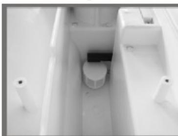
Начните хлопчатобумажную ткань спиртом или медицинским дезинфицирующим средством, чтобы очистить стенки бака, затем промойте дистиллированной водой и высушите бак. После этого следует вынуть фильтр, помыть его и просушить.
