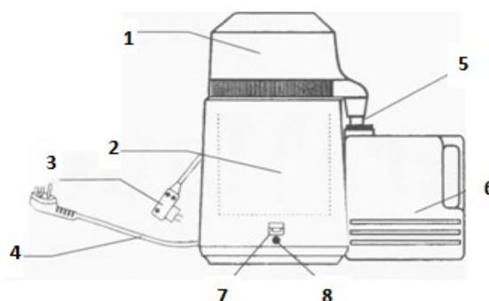
Рисунок 15 – Составные части и комплектующие дистиллятора
