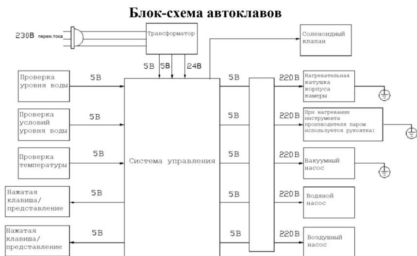
Рисунок 22 – Блок-схема
