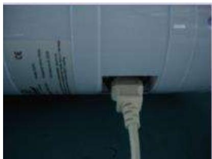
Подсоедините устройство к источнику электропитания AC230V50HZ. Нажмите кнопку включения устройства. Устройству SEAL F300A потребуется 2 минуты, чтобы предварительно нагреться. Когда светоиндикатор погаснет, можно приступать к работе.
