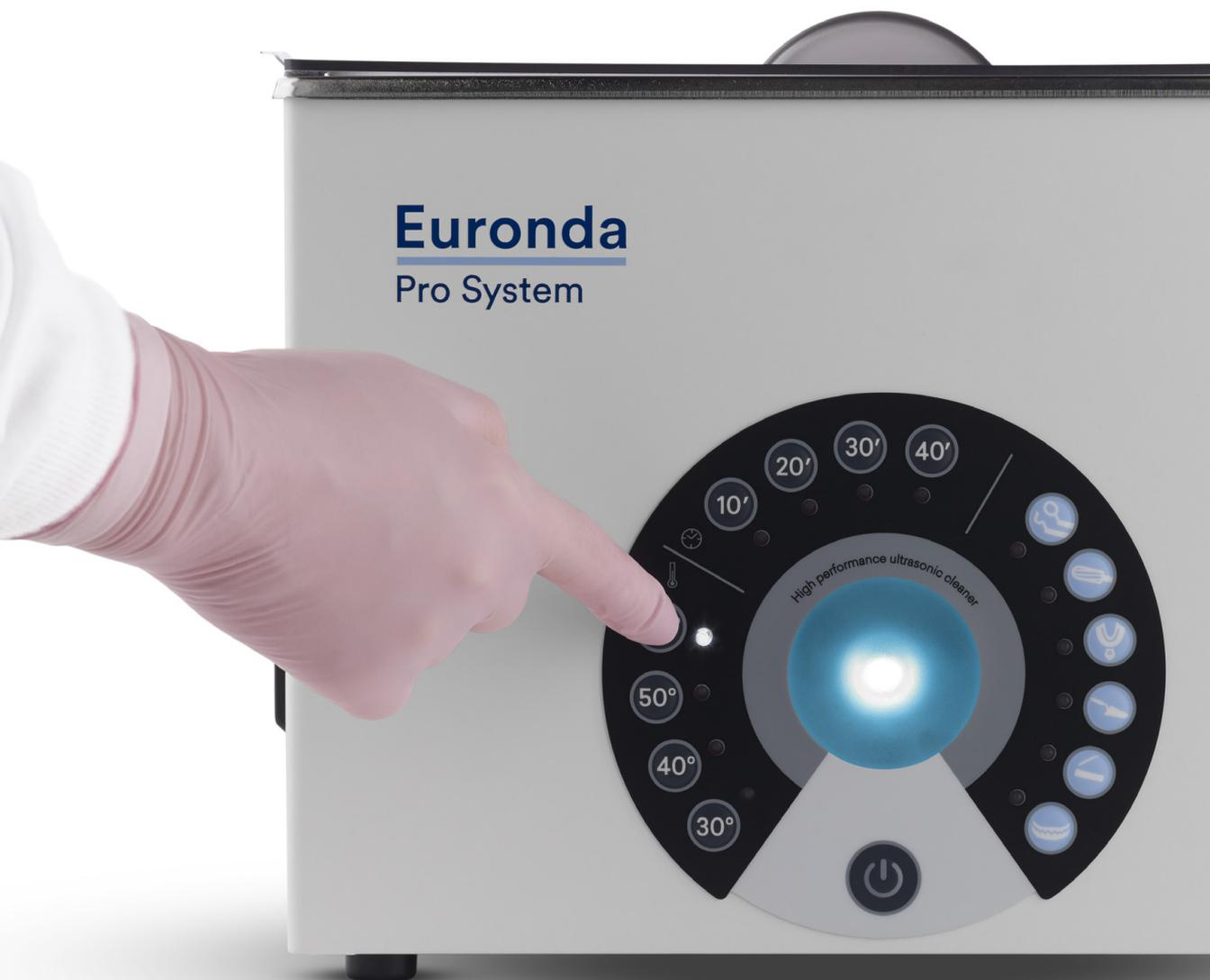
Два рабочих режима позволяют выбрать между 6 предустановленными циклами (инструменты, боры, слепочные ложки, удаление цемента, удаление гипса, протезы), и свободными циклами, с возможностью установить температуру от 30°C до 60°C и время работы от 10 до 40 минут. 6 запрограммированных циклов предполагают 4 фазы работы: Degas, Boost, Normal, Sweep. Eurosonic® 4D оснащена задним сливом с краном и трубкой, а также боковыми ручками, которые обеспечивают возможность удобного переноса машины.
