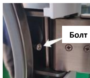
2. С помощью шестигранного ключа по направлению вниз ослабить болт за крышкой камеры.
