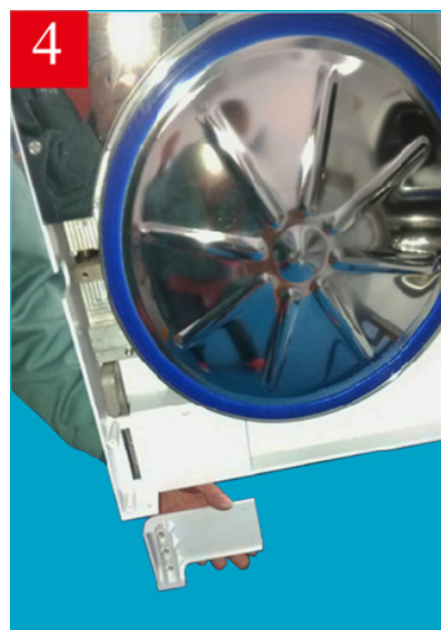
4. Ручку двери снять снизу.
