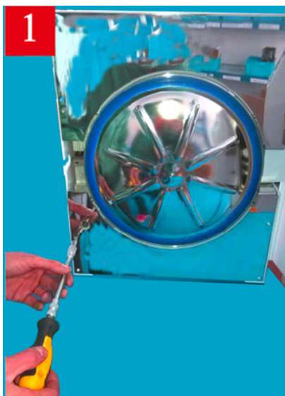
1. Снимите нижнюю часть металлической пластины.
