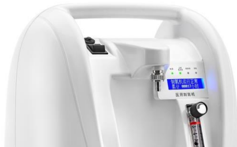
Рис. 7. Вверните штуцер в отверстие для выхода кислорода
