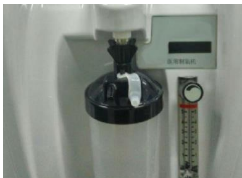
Рис. 9. Оптимальное размещение емкости для увлажнения в концентраторе кислорода
